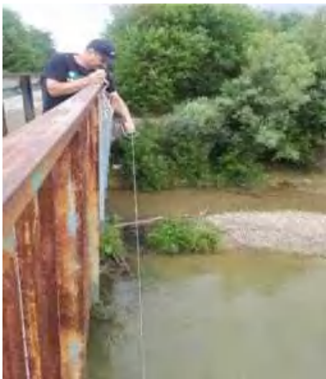
Рисунок 3.2.1. Вимірювання рівня води під час паводку 2021
